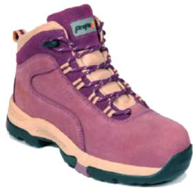
**Construcción:** Cementado. **Fabricación:** Cuero Nobuck. **Forro:** Napa y cuero gamuzado. **Cuello y suplente:** Napa acolchada. **Planta:** Bimaterialidad (Caucho Acrilo Nitrilo/EVA) resistente a hidrocarburos y aislante eléctrica. **Pasacordones:** Cinta tejida extra resistente. **Plantilla interior:** Preformada intercambiable. **Punta de seguridad:** Acero templado de lata resistencia según Norma NCh 772/2. **Numeración:** 34 al 40. **Color:** Morado.
