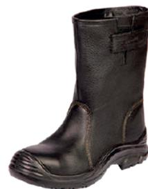
**Construcción:** Inyección directa al cuero. **Fabricación:** Cuero plena flor estampado con costuras de Kevlar ( resistente altas temperaturas) en punta y talón. **Forro:** Cuero gamuzado. **Planta:** Poliuretano (PU) Bidensidad resistente a hidrocarburos y aislante eléctrica. **Plantilla Interior:** Preformada intercambiable. **Punta de seguridad:** Acero templado de alta resistencia según norma NCh 772/2. **Numeración:** 38 al 46. **Color:** Negro.
