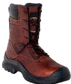
**Bota de seguridad:** Inyección al cuero. **Fabricación:** Cuero Grizzly Water resistant. **Forro:** Térmico Thinsulate. **Forro Completo:** Cuero Gamuzado. **Planta:** Poliuretano ( PU). Bidensidad resistente a hidrocarburos y aislante eléctrica. **Plantilla Interior:** Preformada intercambiable. **Punta de seguridad:** Acero templado de alta resistencia según norma NCh 772/2. **Numeración:** 38 al 45.
