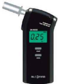
El test de alcohol DA-8000 es un detector de alcohol de última generación basado en la tecnología de sensores de celda de combustión que permite tener resultados con absoluta precisión.
