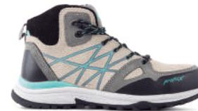
**Construcción:** Cementado. **Aparado:** Cuero Nobuck. **Planta:** Bimaterialidad (caucho acrílico nitrilo / EVA) resistente a hidrocarburos y aislante eléctrica. **Puntera:** Composite de alta resistencia según Norma NCh 772/2. **Plantilla de Armado:** Penetration Proof (anticlavo), compuesta por fibras de poliamida sintetizada (Kevlar), resistente a la perforación según norma NCh 1797 of. 90. **Plantilla Interior:** Preformada intercambiable, EVA/Poron con tratamiento antimicótico.
