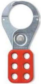
Tiene un diámetro de la mordaza interior de 25 mm y tiene capacidad para hasta seis candados. Ideal para bloqueos realizados por múltiples trabajadores en cada punto de bloqueo, la aldaba mantiene el equipo inoperativo mientras se realizan reparaciones o ajustes. El control no se puede activar hasta que se retire el último candado de los trabajadores de la aldaba.
