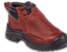
**Construcción:** inyección directa al cuero. **Fabricación:** cuero Avalanche Graso. **Protección Metatarsal:** de acero forrada en cuero. **Forro:** cuero gamuzado y aislante eléctrico Thinsulate. **Cuello y suplente:** napa acolchada. **Planta:** Poliuretano (PU) resistente a hidrocarburos y aislante eléctrica. **Plantilla interior:** preformada intercambiable. **Punta de seguridad:** acero templado de alta resistencia según norma NCh 772/2.
